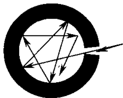
图 17.2 带有小孔的空腔 作为黑体的模型
