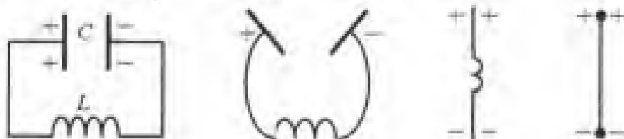
图 14.4 电磁波的发射
